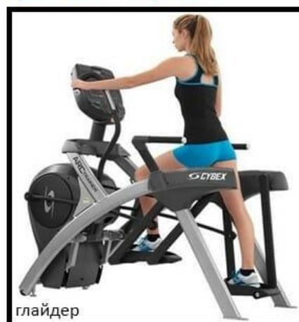
Эллиптические тренажеры чаще всего управляются ногами тренирующегося. В этом случае тренажеры представляют собой комбинированные конструкции с рычагами, прикрепленными к каждой pedalной платформе, чтобы обеспечить некоторую нагрузку на плечи и
